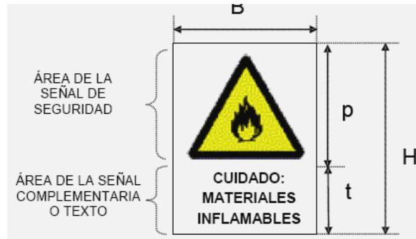
Los carteles serán de un material que resista, lo mejor posible, los golpes, las inclemencias del tiempo y las agresiones medioambientales, podrán estar fabricados de materiales metálicos (chapa de aluminio, acero, etc.), plástico (metacrilato, policarbonato, PVC, ABS, etc.), o cualquier otro. A solicitud del comprador, el fabricante definirá el material de la placa.
