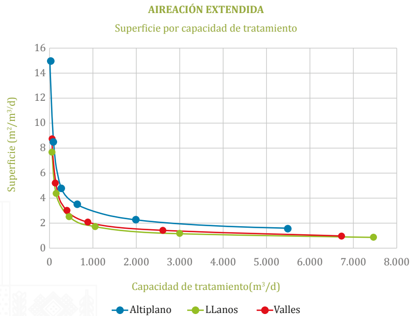
Figura 7.194. Requisitos de superficie por capacidad de tratamiento.
