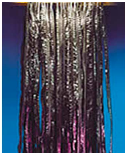
Figura 7.113. Material de soporte "sessil" empleado en la PTAR de Puchukollo.
