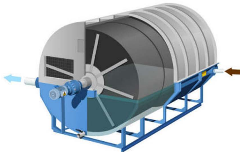
Figura 7.177. Entrada y salida en un Contactor Biológico Rotativo.
