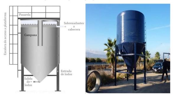
Figura 11.1. Espesador por gravedad estático.
