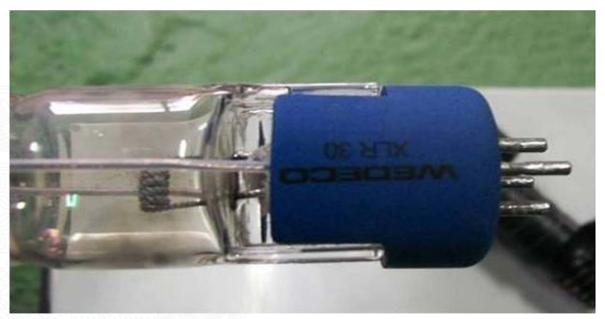
Figura 9.9. Lámpara de vapor de mercurio.
