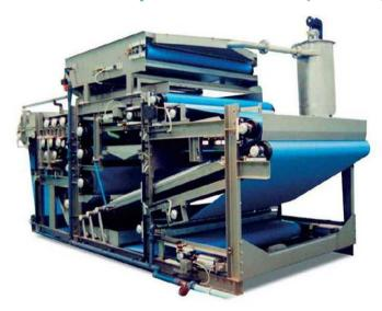
El parámetro de diseño de este tipo de dispositivo para la deshidratación de lodos es la carga por ancho de banda, con un máximo de 250 kg SS/m/h para lodos estabilizados vía anaerobia y de 125 kg SS/m/h para lodos estabilizados vía aerobia. Siendo el ancho de banda máximo recomendado de 2,5 m, dado
